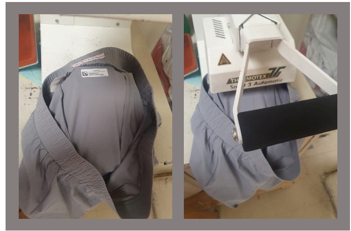
Presse à thermofixé, colle l'étiquette sur le vêtement.
